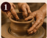
1 LE TOURNAGE L'argile est travaillée à la main ou au tour pour donner forme au tajine.
