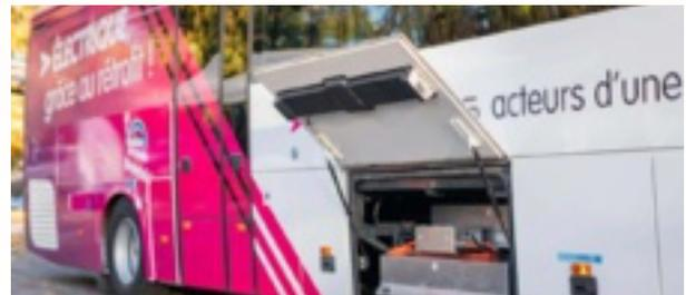
Un ancien autocar Iveco Crossway de 2015 a été transformé en un modèle électrique, marquant une avancée significative dans l'adoption de la mobilité propre pour le transport scolaire. La conversion, coûtant environ 200 000 euros par véhicule, ouvre la voie à une transition progressive et économique vers une flotte d'autocars électriques dans la région.
